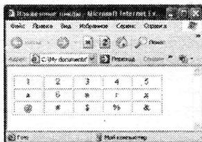
Рис. 5.4. Вывод данных многомерного массива с помощью конструкции вложенных циклов
